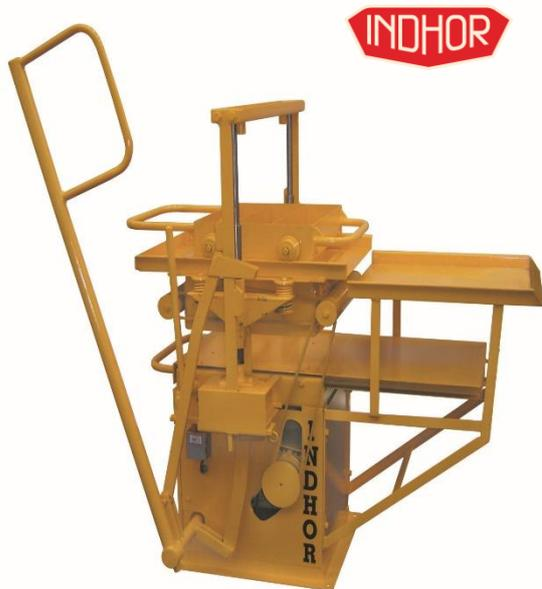
Equipo desarrollado para la fabricación de ladrillos huecos para albañilería y adoquines para pavimentado de hormigón vibrado de alta calidad.
