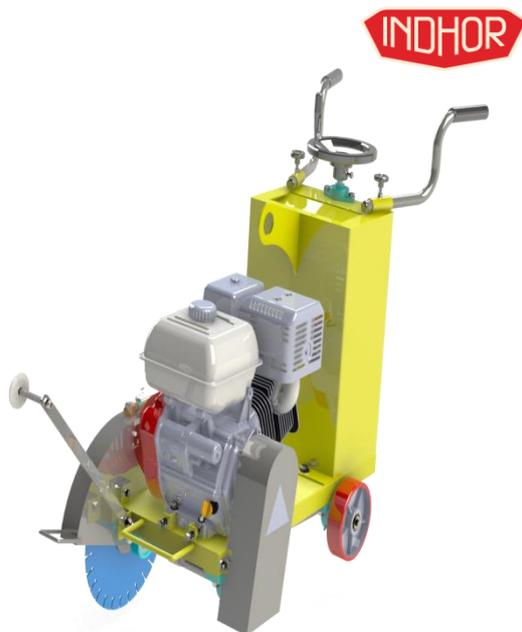
Apta para discos de corte de diamante desde un diámetro de 350 - 450 mm y 3 y 6 mm de espesor. De fácil operación y peso reducido para una mayor maniobrabilidad. Regulación de profundidad de corte por medio de manivela.
